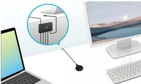
本体ボタンに加え、付属の有線リモコンでのPC切替も可能。ドッキングステーション本体はデスク裏に設置して、利用者による無用な操作を防ぎます。
